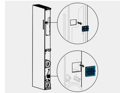
4. Entfernen Sie die beiden Filterkappen.
