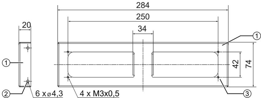
Abbildung 3: Maßzeichnung Schieberhülse V-284x74x20
