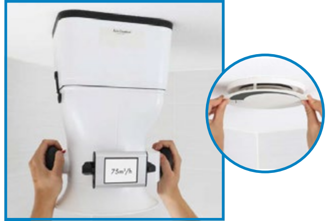
7 Einmessen der Luftmenge Einstellung des Ventils
