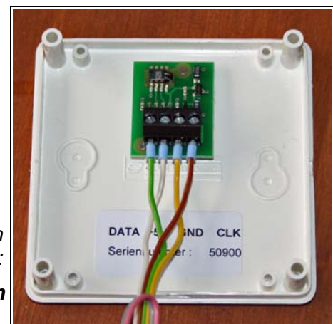
Rechts, Farbfolge am Sensor von links: gn-ws-ge-bn
