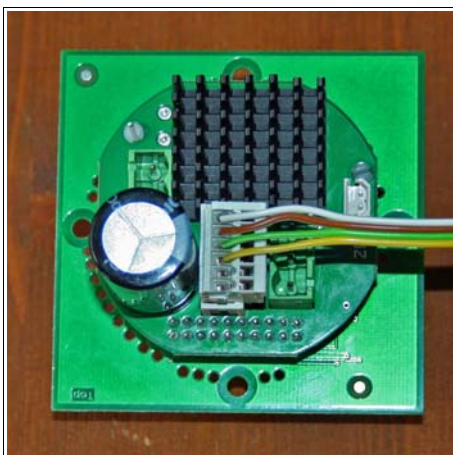
Links, Rückseite der Reglerplatine von oben: ws-bn-gn-ge(-frei-frei)
